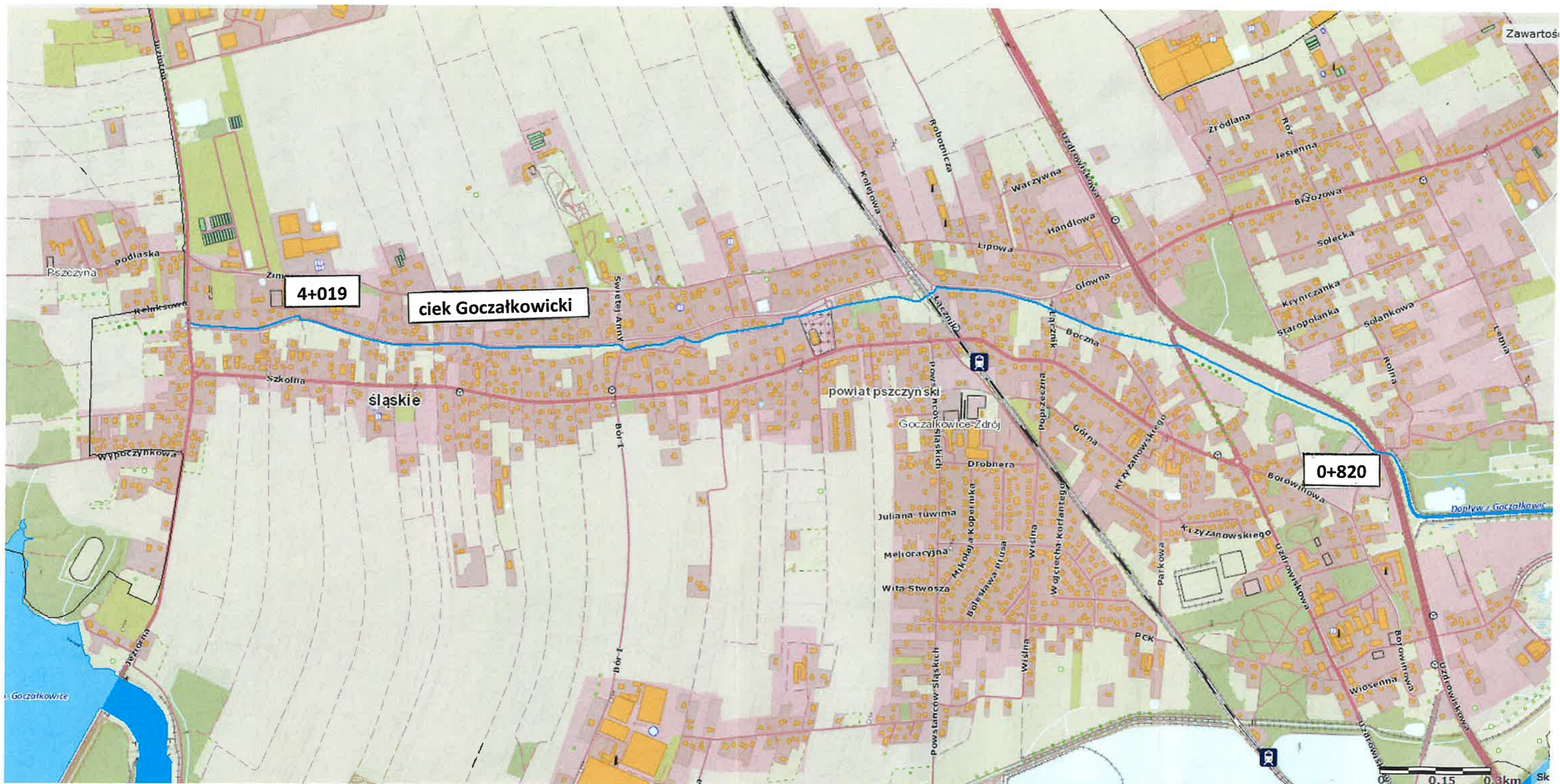
Wykonanie konserwacji (utrzymanie): ciek Goczałkowicki w km 0+820-4+019, m. Goczałkowice-Zdrój, gm. Goczałkowice-Zdrój (rozmiar rzeczowy: 3,199 km)
